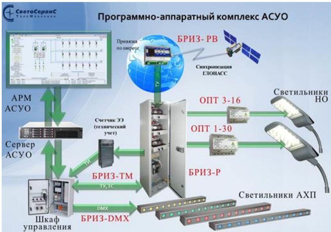
Рисунок 1 - Схема организации управления АСУО «БРИЗ»
